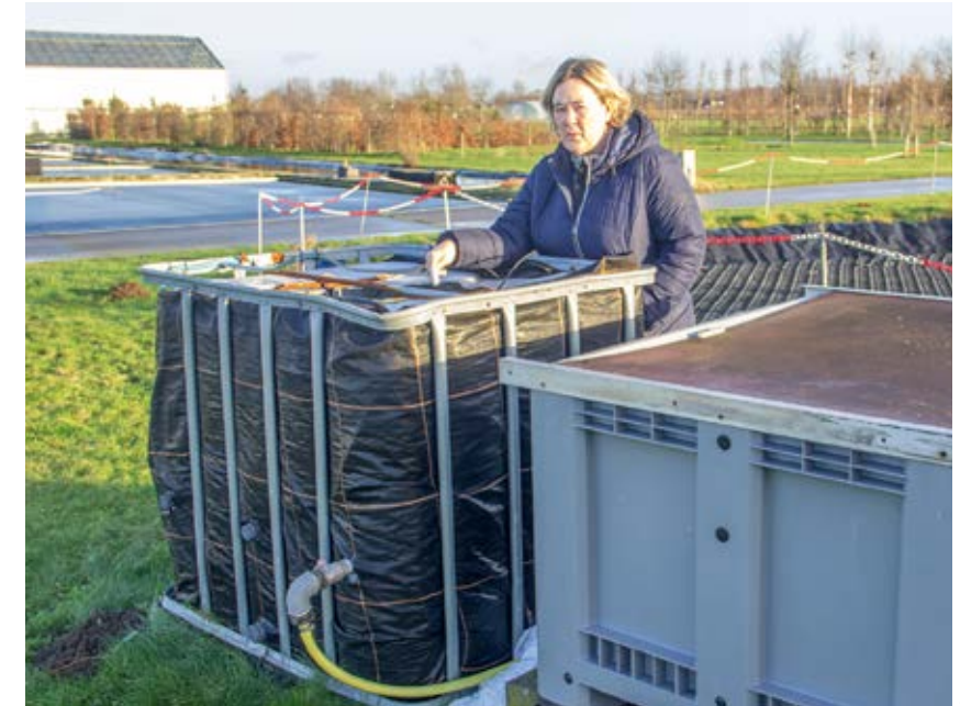
Marijke Dierickx toont de MBBR, die ook de nitraten uit het water haalt, maar op een veel beperkter oppervlakte als de rietvelden.
